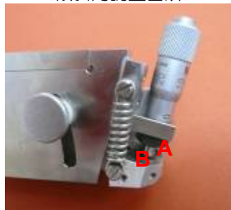
＜傾斜角調整箇所＞
